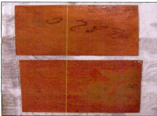
Fig.13 – camp.1 e 3 Rame dopo 24 h di esposizione
