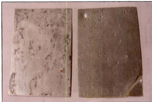
Fig.8 – camp.1(electric) e 3 Alluminio dopo 192 h di esposizione
